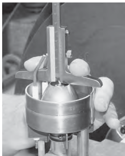
Misurazione della distanza tra ugello dell'aria e ugello dell'olio combustibile
