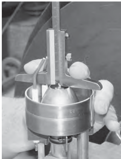
Messung Abstand Öldüse – Luftdüse
