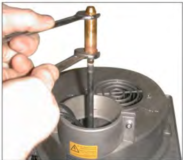
Рис. 40 Замена топливной дюзы
