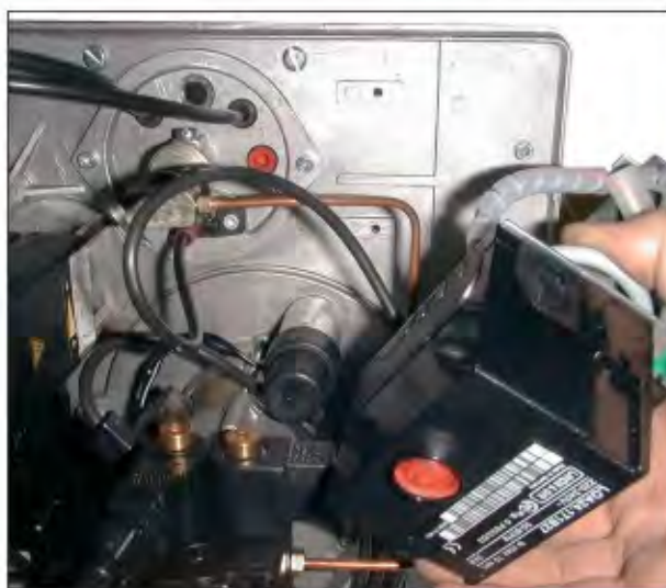
Рис. 39 Демонтаж блока Евроразъёма и блока управления горелки
