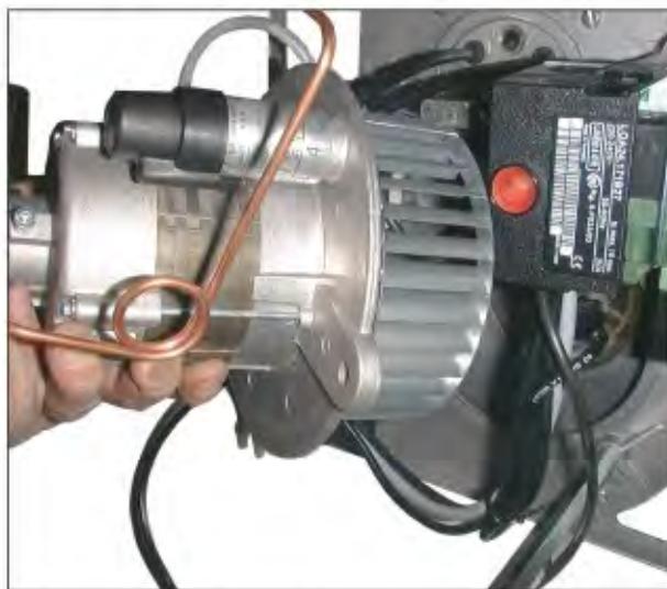
Рис. 37 Демонтаж двигателя вентилятора горелки
