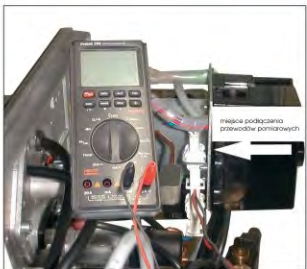
Рис. 44 Замер параметров фотозлемента
