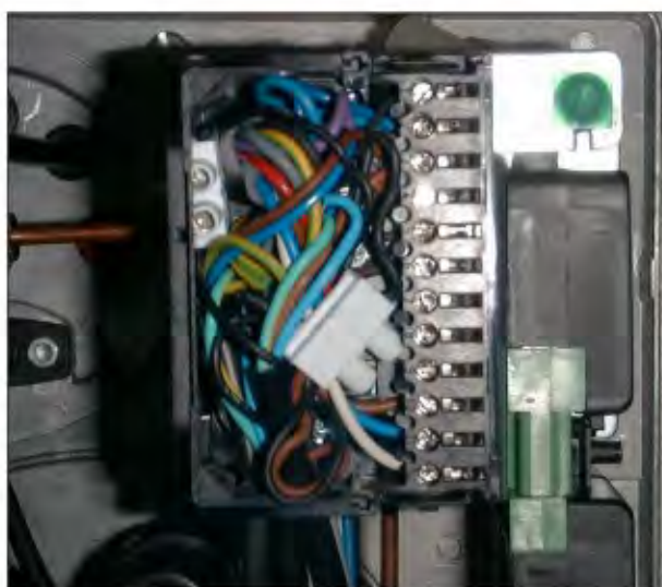
Рис. 45 Клемник блока управления
